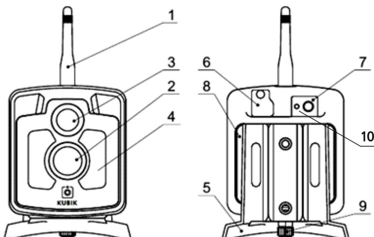
1. антенны для приема GSM-сигнала
